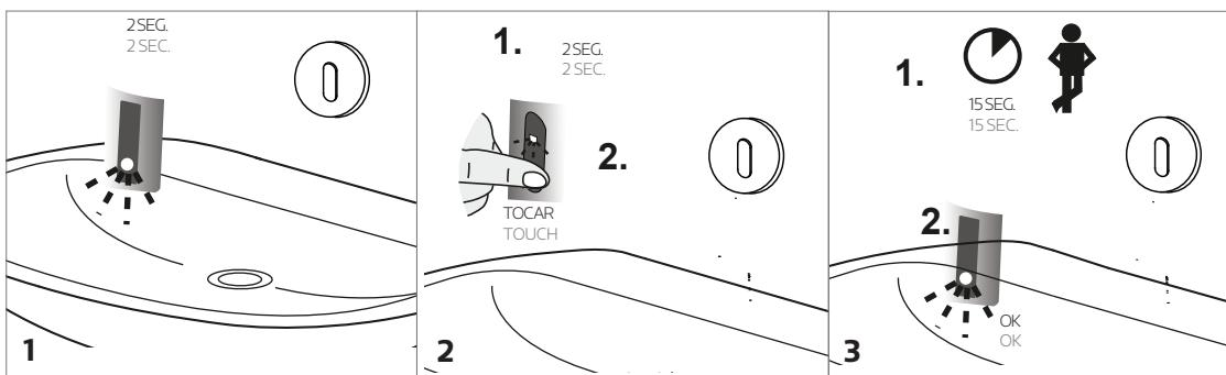
O sensor utilizado tem uma configuração standard: 2 segundos de abertura e 12 cm distância.
